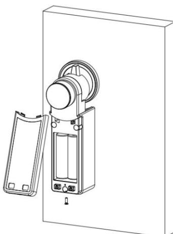
**5.** Instale o painel externo na própria porta ou em uma parede próxima. Escolha a posição desejada e fixe o suporte do painel com parafusos ou película adesiva;
