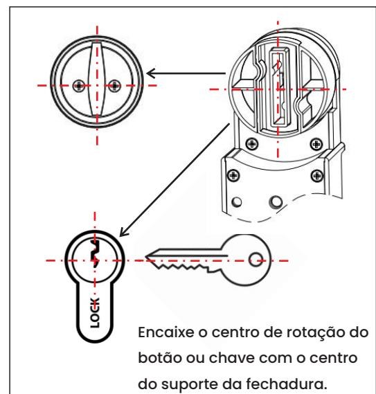
**2.** Para fixar a fechadura à porta, existem dois métodos:
