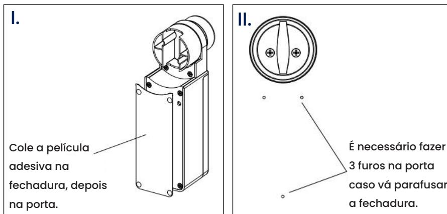
**3.** Revise se a fechadura está encaixada corretamente com o centro de rotação da chave ou botão giratório da porta girando o botão giratório da fechadura, então cole ou parafuse a fechadura na porta;
